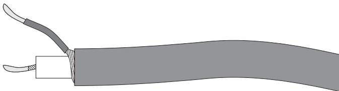
Colocar termocontraible de 4mm en la malla
