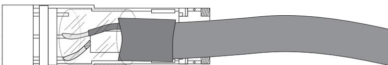
Coloque la pieza (5),(4) y Cable en la pieza (6) respetando el encastre de las piezas (5) y (6)
