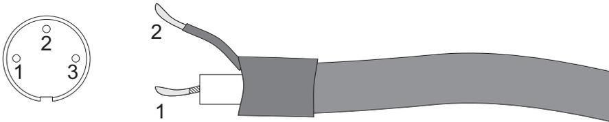
Suelde los extremos del cable a la pieza (5) maya con el pin 1 y conductor central con el pin 2
